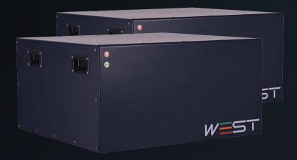
La Serie Summit de WEST utiliza nuestra avanzada tecnología de almacenamiento con Supercondensadores Optimizados. Los beneficios incluyen degradación insignificante a lo largo de su vida útil, carga y descarga ultrarrápida, sin riesgo de fuga térmica, operación simple, ciclos prácticamente ilimitados, rango operativo de -40°C a 65°C y 97% de eficiencia de ciclo completo.
